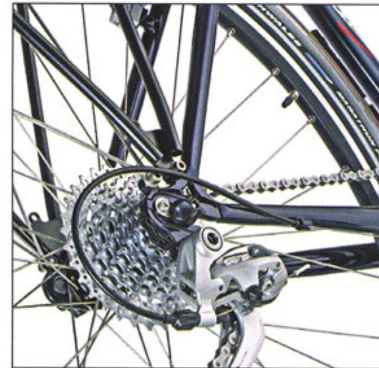
Rohloff-kompatibel: die filigranen Stahl-Ausfallenden
