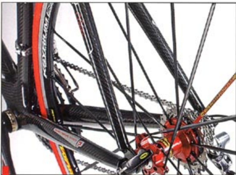
Kurzer Weg, stabile Verhältnisse: die geraden Sitz- und Kettenstreben des Speed
